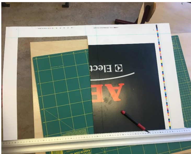
Foto 24. Aluspõhja väljalõikamine noa ja lõikemati abil
